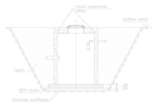
В случае заглубления оборудования с использованием удлинительных горловин песчано-цементную смесь рекомендуется заменить бетоном, а непосредственно над оборудованием необходимо смонтировать разгрузочную плиту, опирающуюся на песко-цементные (бетонные) стенку, возведенную на всю высоту по периметру устанавливаемого оборудования, опирающуюся на выпуск плиты основания.
