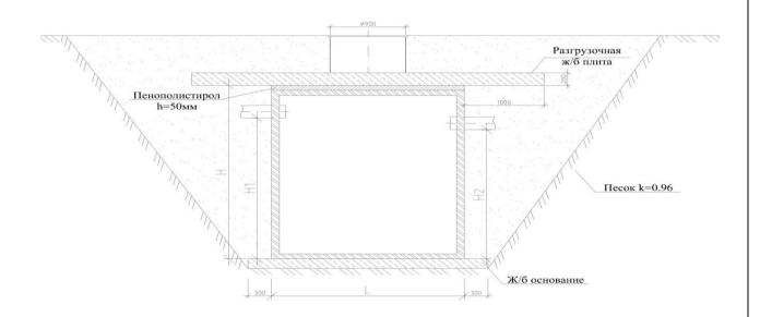
Одновременно с засыпкой оборудования песчано-цементной смесью (бетонированием) оборудование заполняется водой равномерно во все отсеки, уровень воды должен превышать уровень засыпки (бетонирования) не менее чем на 200 мм и не более чем на 500 мм.
